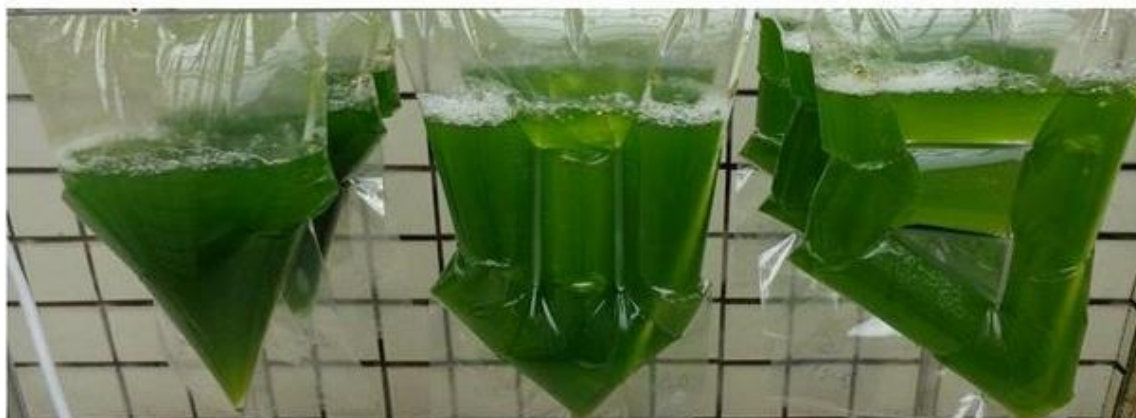
Obr. 4-9 Pytlový fotobioreaktor s různými druhy přepážek [47]
