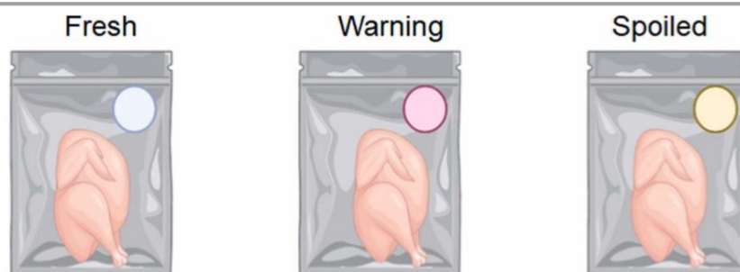
Obr. 3-2 Změna barvy indikátoru stavu potravin v závislosti na degradaci [13]
