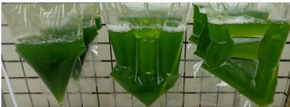
Obr. 4-9 Pytlový fotobioreaktor s různými druhy přepážek [47]
