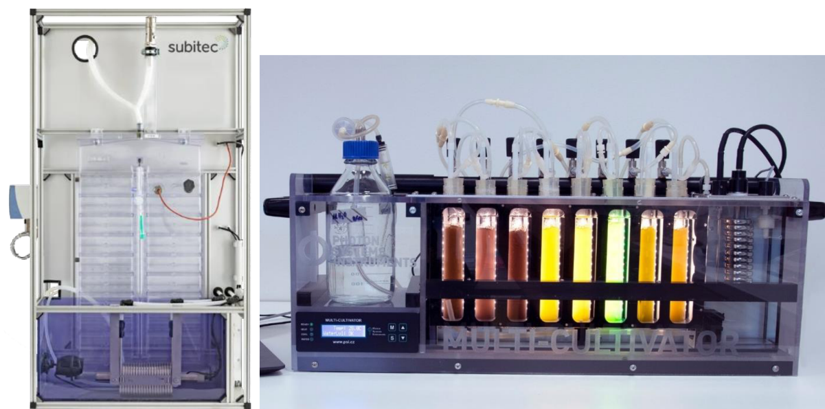
Obr. 4-10 Vlevo laboratorní systém Subitec CM6 o objemu 6 l [48], vpravo Multi-Cultivator MC 1000 od firmy PSI [25]
