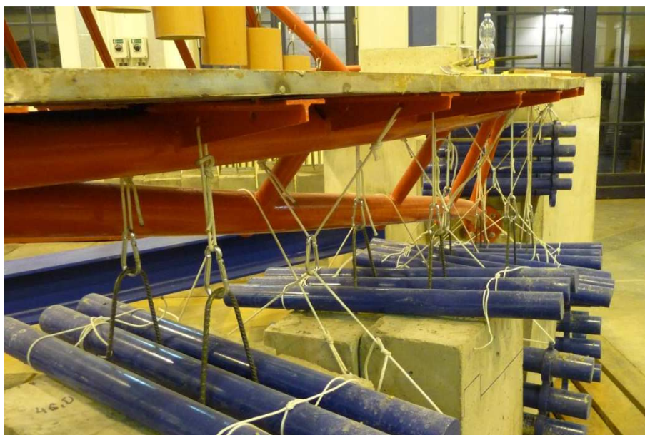
Obr. 168 – Trvalá deformace oblouku po limitní zkoušce
