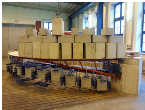
Obr. 143 – Druhá poloha proměnného zatížení pro limitní zkoušku
