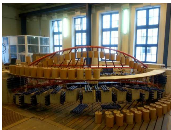
Obr. 138 – První poloha proměnného zatížení pro MSP
