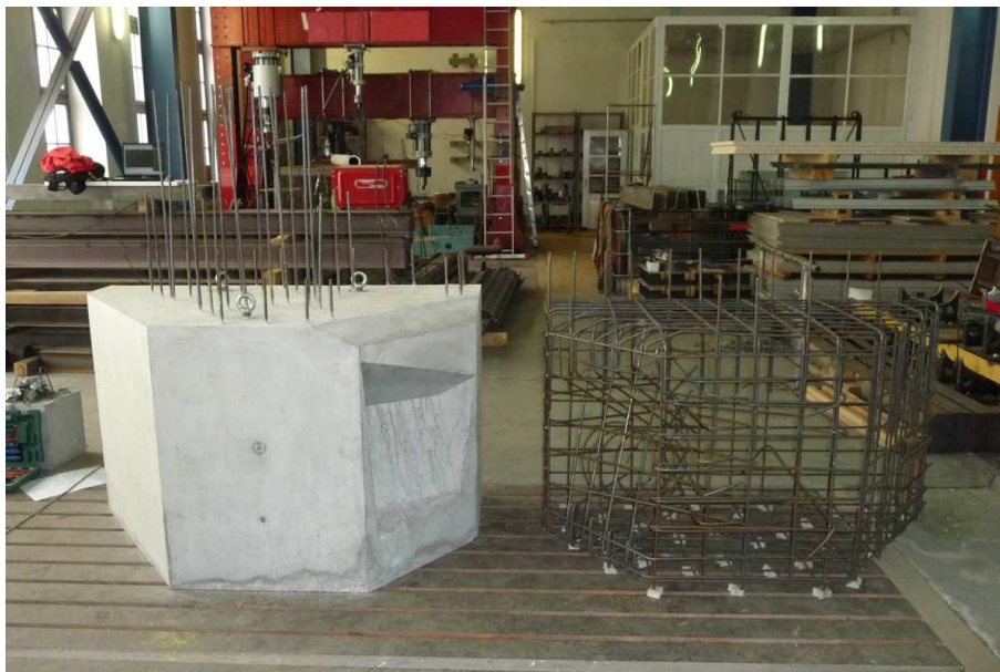
Obr. 133 – Základový blok Z1 a armokoš základového bloku Z2 ve zkušebně
