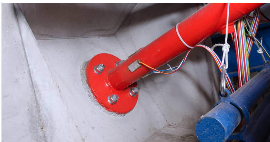
Obr. 135 – Tenzometry na oblouku
