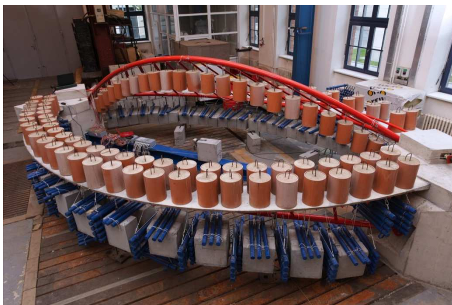
Obr. 169 – Fyzikální model půdorysně zakřivených obloukových konstrukcí během testování
