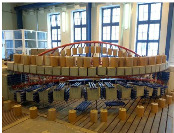
Obr. 141 – Poloha proměnného zatížení pro MSÚ
