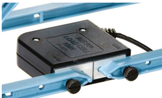
Obr. 1 Siloměr pro mostové konstrukce[35]
