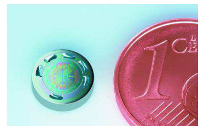
Obr. 2.12 Snímač s filmovým implantátem [12]
