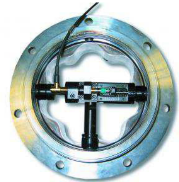
Obr. 3.8 Měřidlo oběžných drah ložisek [31]
