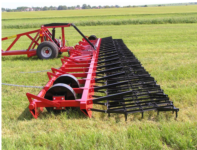
Obr. 12 Smykové brány s opěrnými koly
