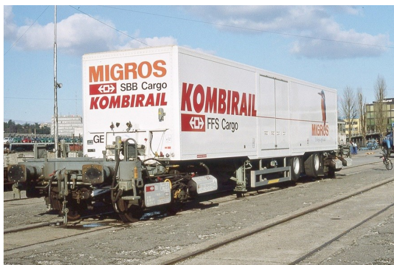
Obr. 1.3.6 Bimodální návěs připojený do podvozku
