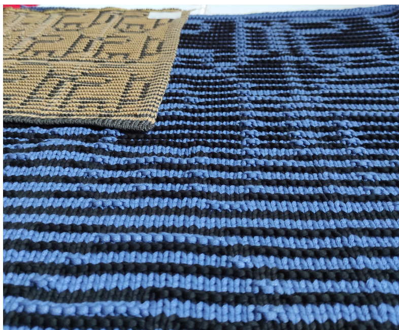
Obr. 20: Zkušební vzorek na stroji s dělením E5 (vlevo) a E3 (vpravo)
