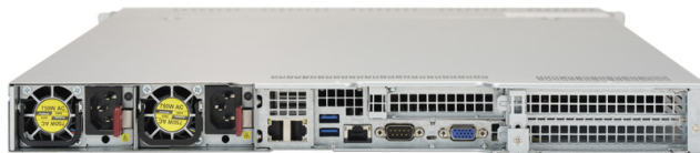
Obrázek 2.6: DDoS Protector na 1U Supermicro SuperServer 1028U-TRT+ platformě [11].
