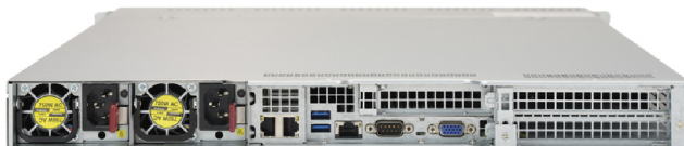
Obrázek 2.6: DDoS Protector na 1U Supermicro SuperServer 1028U-TRT+ platformě [11].
