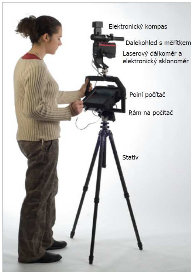
Obrázek 1 - Technologie Field-Map podporuje rozsáhlou škálu elektronických měřících zařízení nejčastěji se používá kombinace elektronického sklonoměru, dálkoměru a kompasu pro měření vzdáleností a vertikálních i horizontálních úhlů při trojrozměrném mapování lesního prostředí
