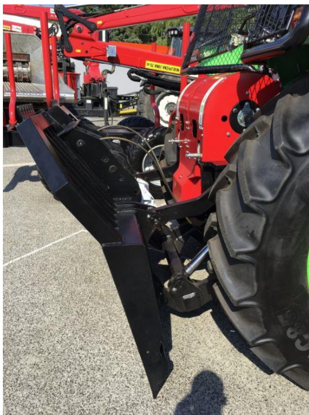
Obr. 6 Agama typ AGA 7 dvoububnový pevný naviják [22]
