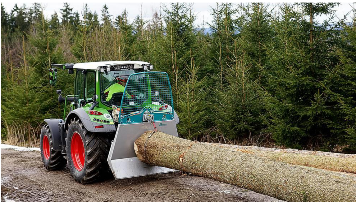
Obr. 4 Naviják Pfanzelt v agregaci s traktorem Fendt [21]
