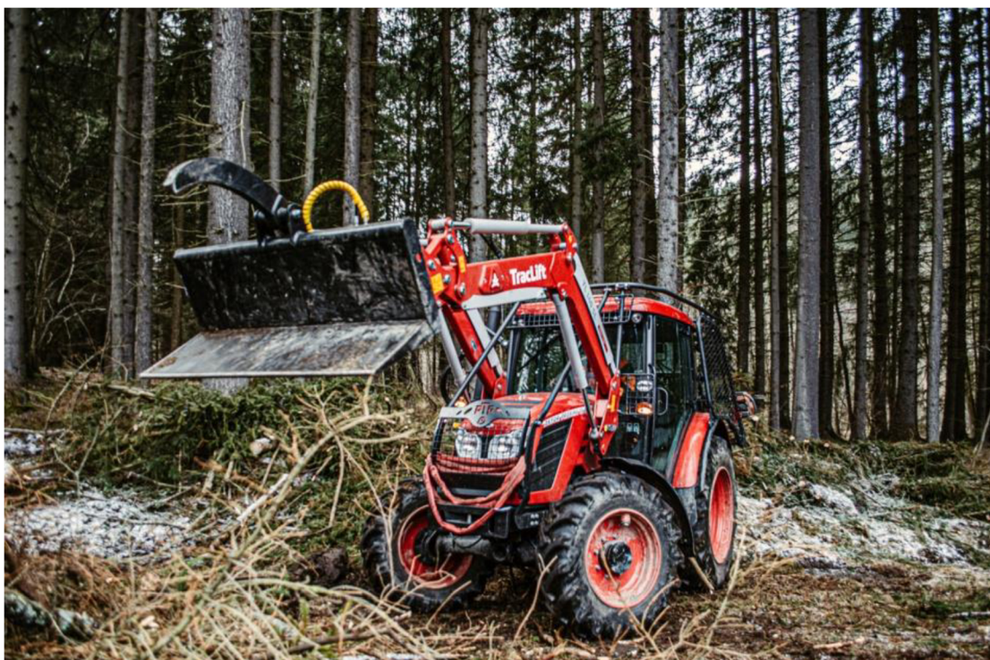
Obr. 3 Univerzální kolový traktor Zetor Proxima CL s lesní nástavbou [17]
