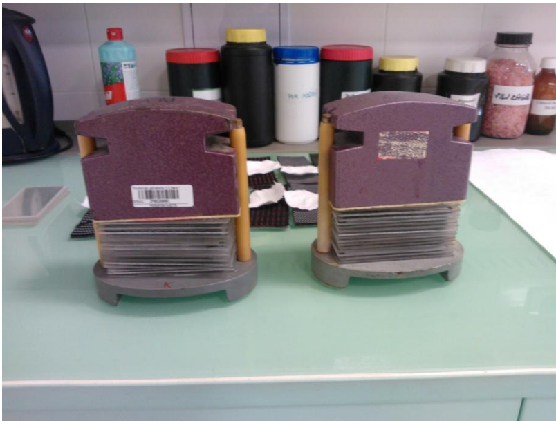
Obr. 28 Zkušební vzorky zatížené závažím o tkaku 12,5 kPA [zdroj: vlastní]
