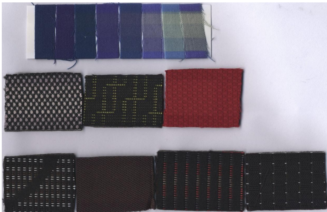
Obr. 24 Vzorky po 72 hodinách v SUNTESTU CPS+ [zdroj: vlastní]
