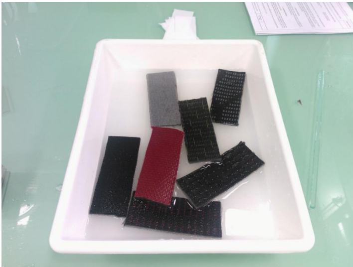
Obr. 27 Testované vzorky ponořené v alkalickém prostředí [zdroj: vlastní]
