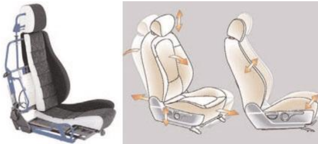
Obr. 1 Sedadlo v řezu a základní polohování u dnes vyráběných autosedadel [1]
