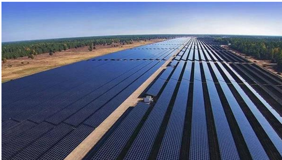
Obrázok 8: CdTe panely v meste Brandenburg, Nemecko [13]
