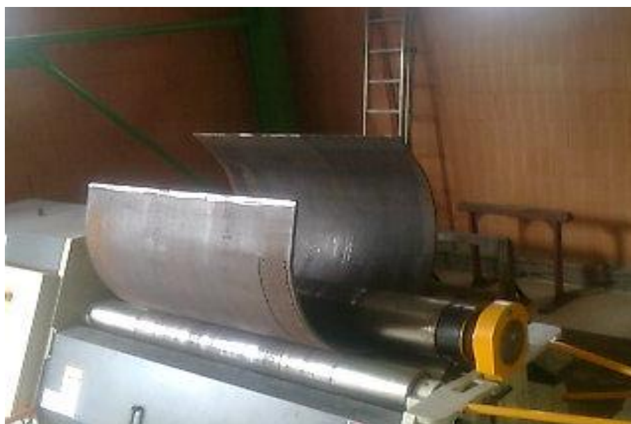
Obr. č. 18 - Skružování pláště
