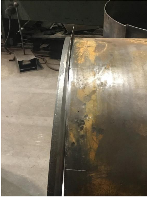
Obr. č. 24 - Montáž příruby s pláštěm
