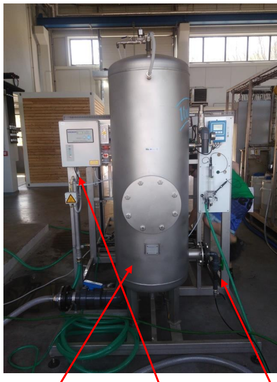
Obrázek 9.4 Reakční kontejner s destruktozem ozonu a vzorkovacím místem
