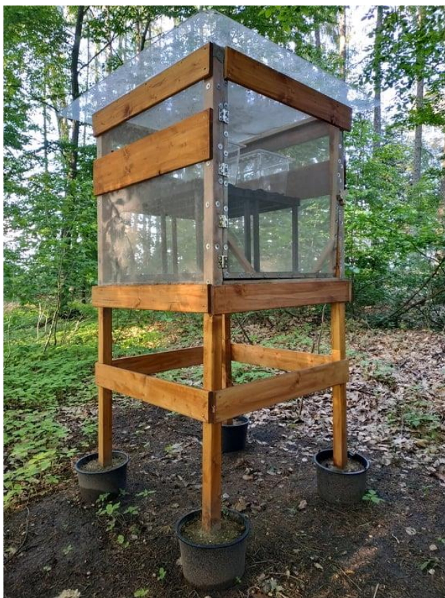
Obrázek 5: Elektromagneticky odstíněná klec. Na výrobu této klece byly použity pouze nemagnetické materiály (archiv autora).
