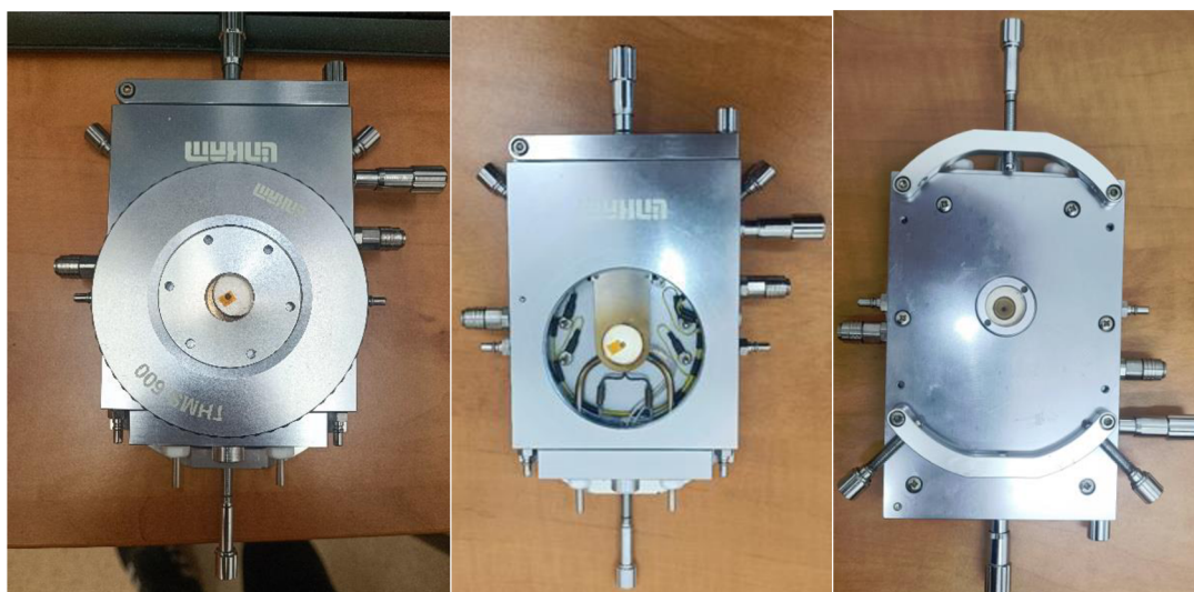
Obr. 10 nalevo je THMS600 z přední strany, uprostřed bez vrchní víka a vpravo ze zadní strany (zdroj: autor)
