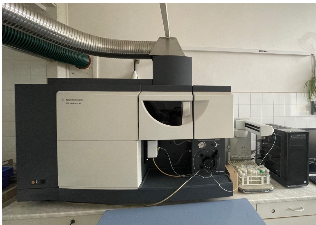
Obrázek 14 Agilent Technologies 700 Series ICP-OES
