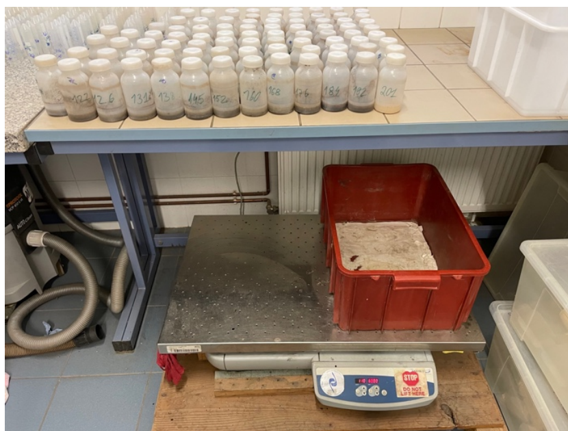
Obrázek 16 Vzorky po třepání určené k centrifugaci
