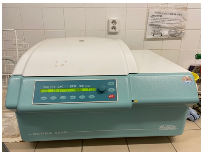
Obrázek 8 Stolní centrifuga Rotina 420 R
