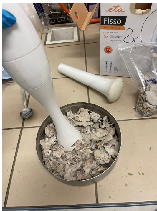
Obrázek 11 Drcení lyofilizovaných vstupních surovin — nasávaná kartonáž (proložky)
