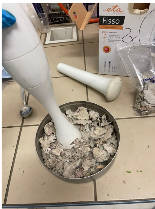
Obrázek 11 Drcení lyofilizovaných vstupních surovin — nasávaná kartonáž (proložky)
