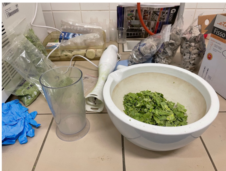
Obrázek 10 Drcení lyofilizovaných vstupních surovin — salát
