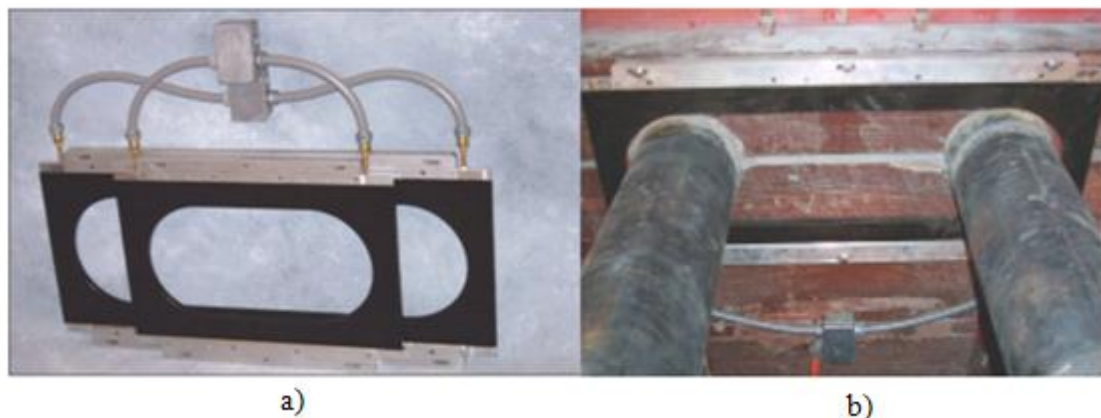
Obr. 5.12: Proudové senzory pro měření na sekundární straně a), a jejich umístění b) [7]
