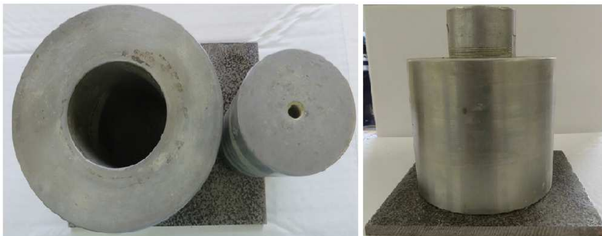
Obr. 19 Lisovací forma pro získávání pórového roztoku
