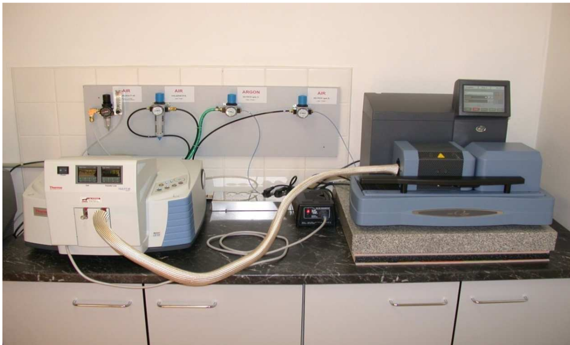
Obr. 16 Uspořádání termické analýzy (IR-analýzátor Thermo Nicolet IS10 a TG-DTA TA Instruments SDT Q600 přepojeno vyhřívanou kapilárou) [64]
