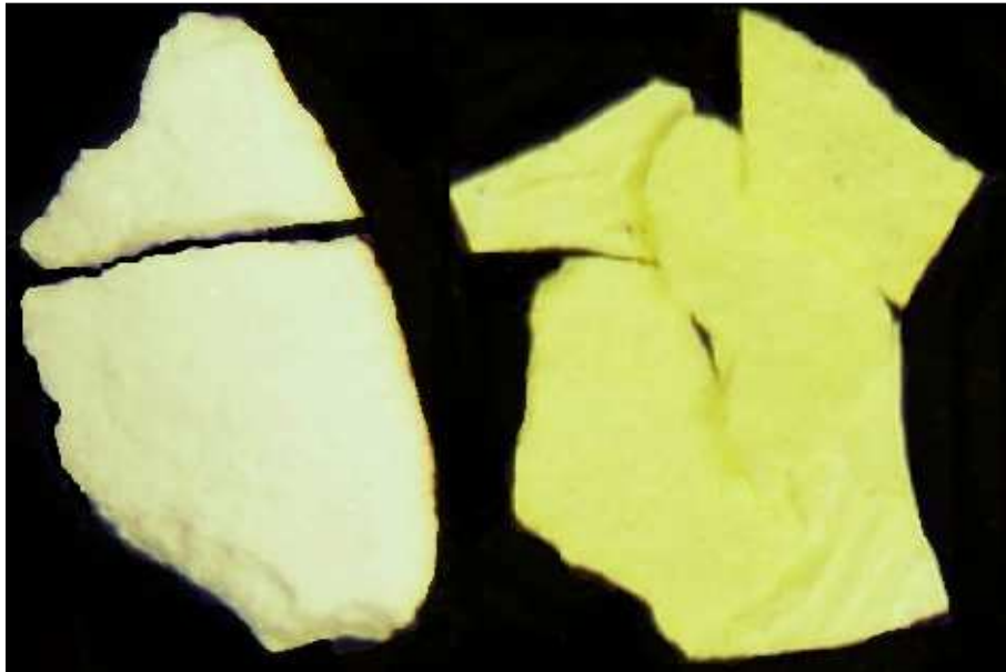
Obr. 54 Vzorek z filtračního koláče hydratačních produktů s obsahem chromu (vpravo) a bez chromu (vlevo)
