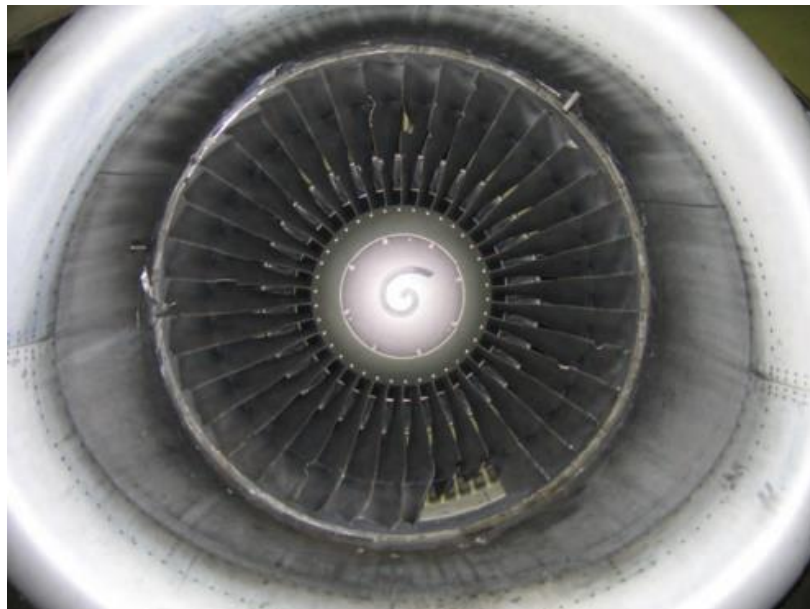
Obrázok 5: Poškodenie motora po strete s vtákom [26]
