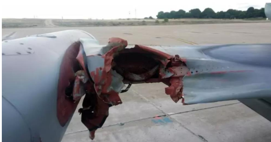
Obrázok 6: Poškodenie krídla lietadla L-159 po strete so supom [29]
