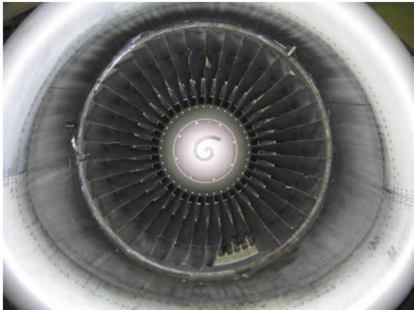
Obrázok 5: Poškodenie motora po strete s vtákom [26]
