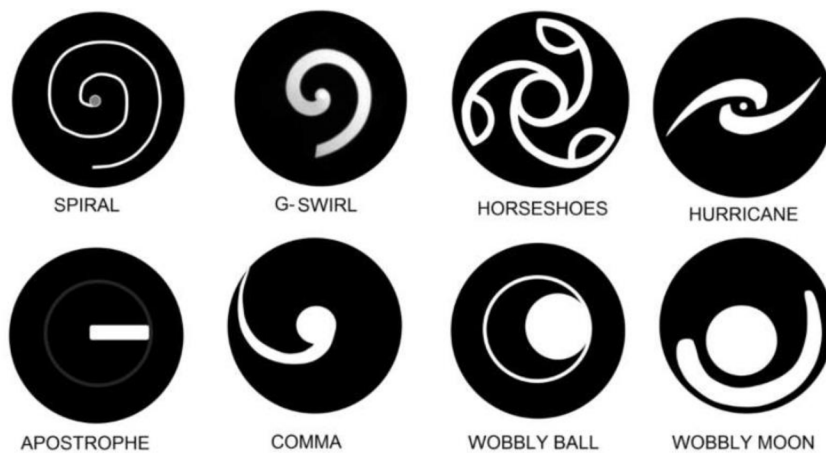
Obrázok 2: Rôzne typy špirál na aerodynamickom kryte náboja dmyhadla [19]
