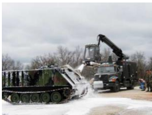
Obrázek 7 Průběh dekontaminace. Kombinace fyzikálních (odstranění kontaminantů) a chemických metod (neutralizace kontaminantů) [29].
