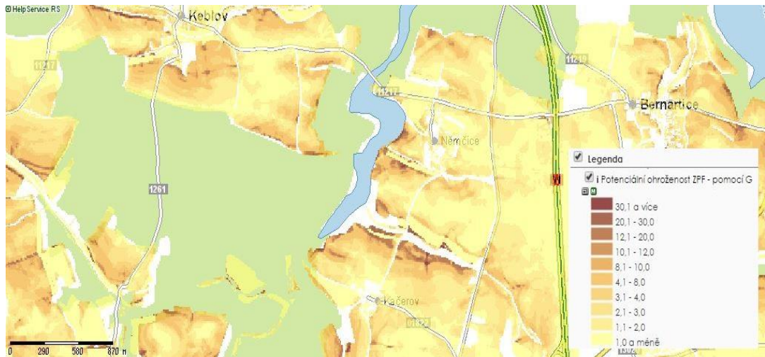
Obrázek 8: Potencionální ohroženost ZPF pomocí univerzální rovnice ztráty půd (USLE). Jednotkou je průměrná dlouhodobá ztráta půdy G [tuna/ha/rok].
