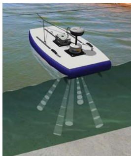
Obrázek 11: Rozmístění měřících paprsků. Uprostřed VB, po stranách BT
