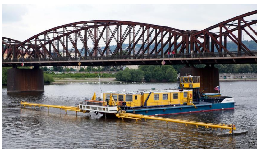
Obrázek 41: Měřicí loď Valentýna II (zdroj: http://technet.idnes.cz/vymerovaci-lod-valentyna-0y1-/ )
