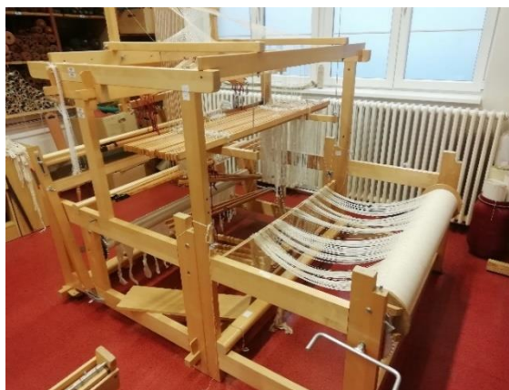
Obr. 14 Příprava osnovního válu před naváděním osnovy
