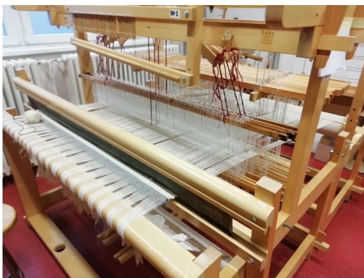
Obr. 21 Navedení všech nití do základního brda a části do brda vzorového
