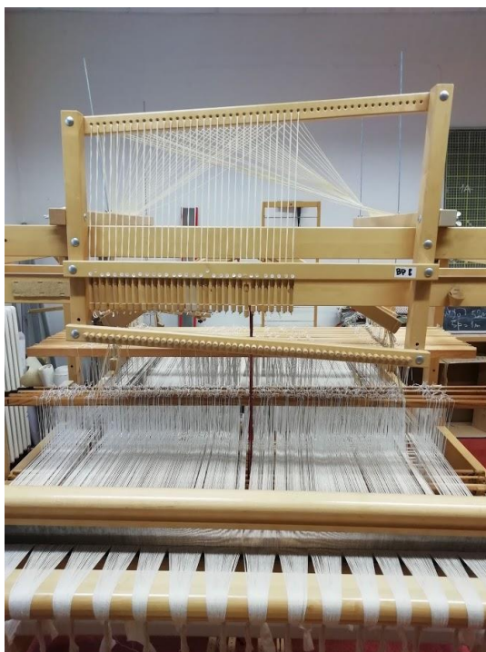
Obr. 26 Umístění količků ovládajících vzorové brdo
