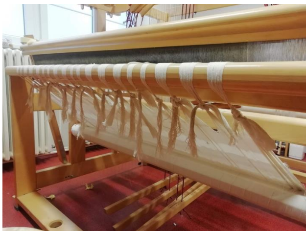
Obr. 23 Upevnění napnuté osnovy ke zbožovému válu
