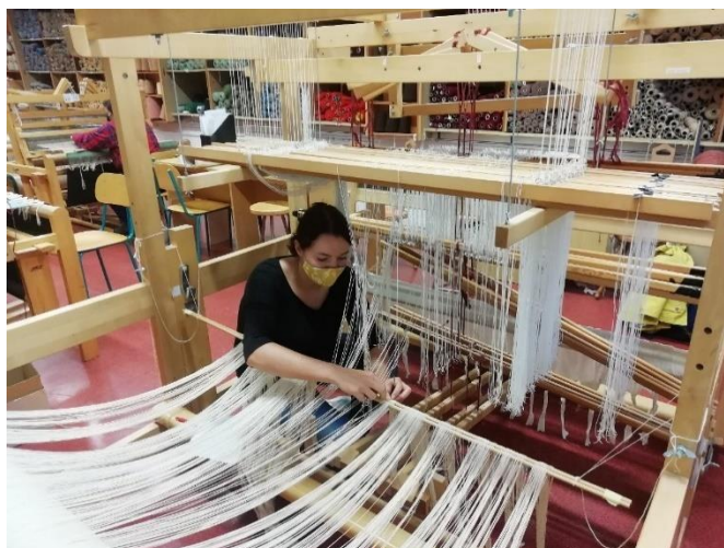
Obr. 20 Proces ručního navádění osnovy do nitěnek
