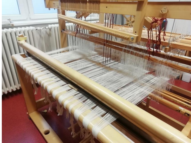
Obr. 22 Možnost navedení osnovy zvlášť do listů základního a vzorového brda
