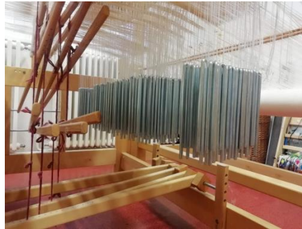
Obr. 15 Ukázka navěšení závaží na každou nitěнку vzorového brda
