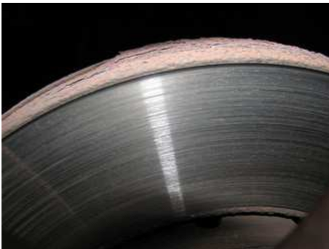
Obr. 7 Obroušená kotoučová brzda (ekolist 2011)
