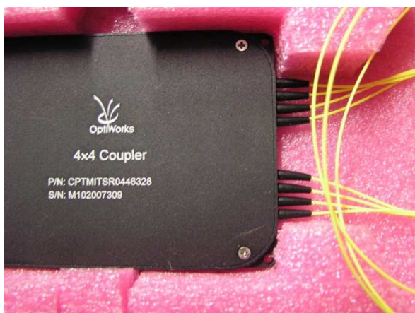
Obr 9.: Coupler 4x4, a navázání laseru na optické vlákno.
