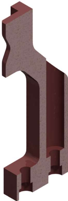
Obr. 41) Prst varianta č. 1.2 v řezu
