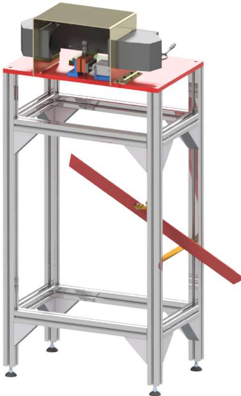
Obr. 80) Stanoviště výstupní kontroly
