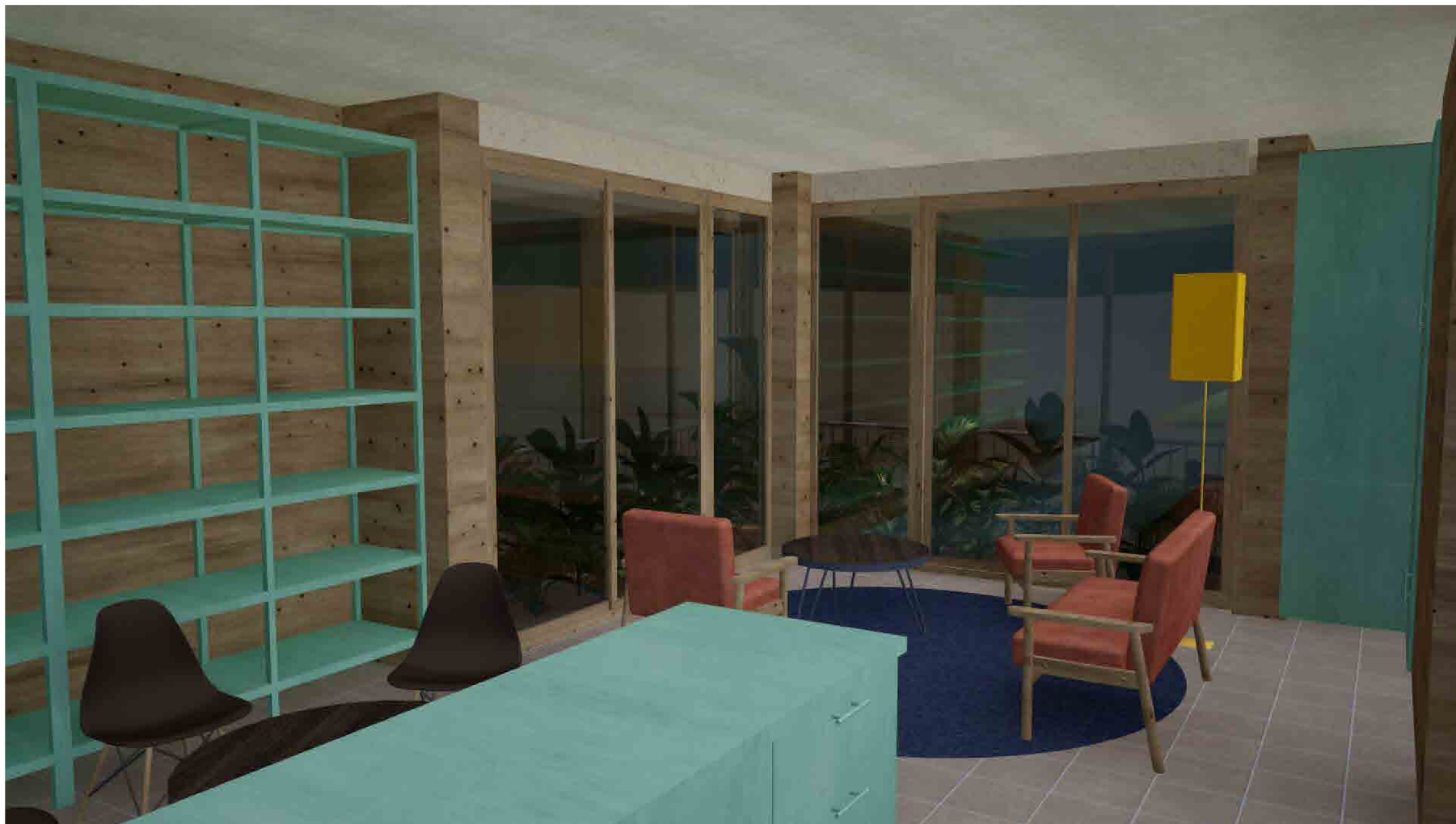
Pohled z kuchyňského koutu. Stěny jsou pohledové ct panely a podlaha je vinylová. Dřevěné rámy oken a ocelový sloupek v rohu obložený dřevem k sjednocení výklenku. Ráno.
