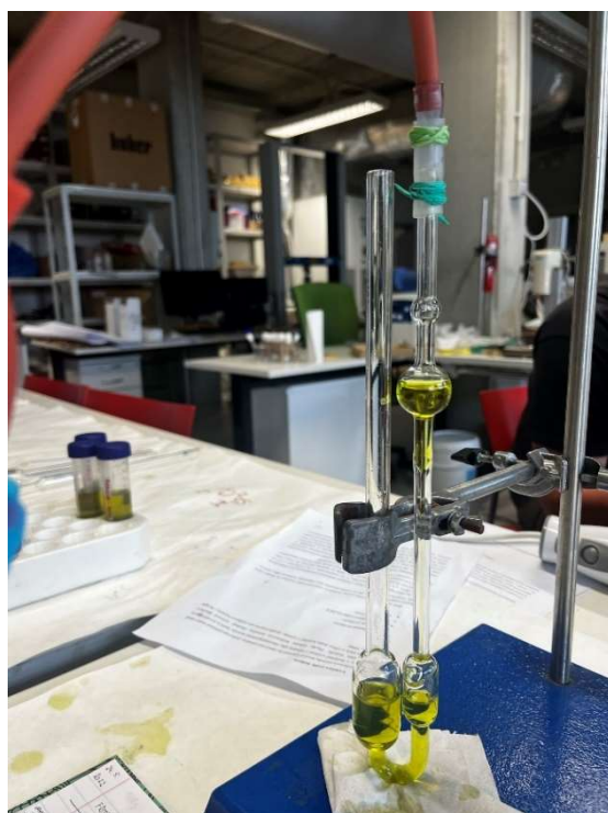
Obr. 4.7: Měření pomocí Ubbelohdeho viskozimetru
