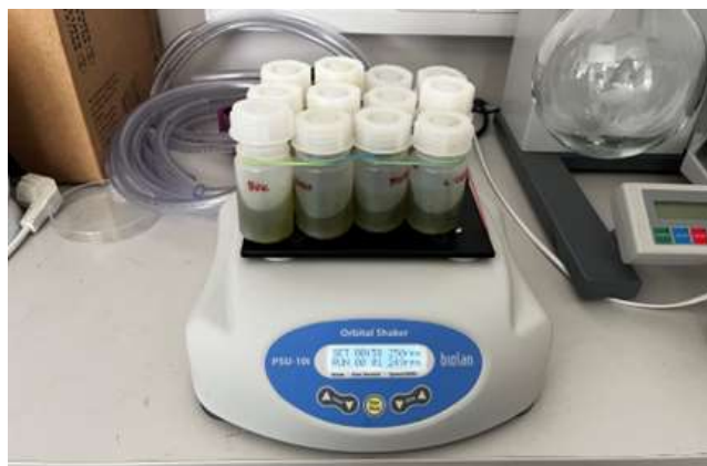
Obr. 4.6: Dezintegrované vzorky \alpha -celulózy po neutralizaci, připravené k sušení
