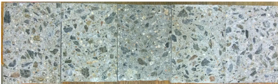
Obrázok 27: Vyleštené vzorky - zľava C 30/37 NA-S, RRCA-S, MRCA-S, VRCA-S, SRCA-S
