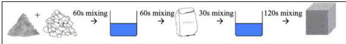
Obrázok 12: Dvojfázový postup miešania betónu [13]
