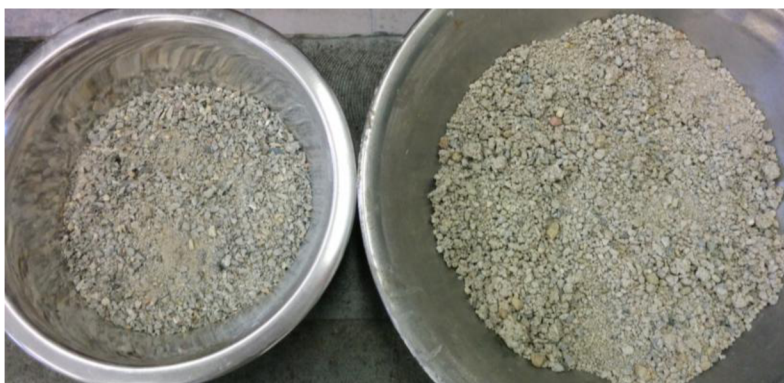
Obrázok 17: Betónový recyklát frakcia 0/4 mm - vľavo Velká Bíteš, vpravo Spiroll
