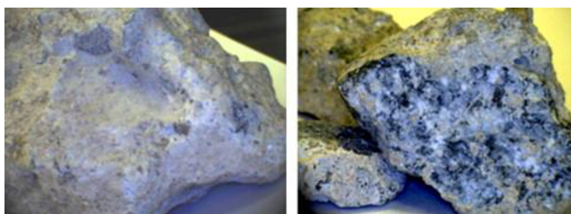
Obrázok 9: Vľavo kamennivo pred mikrovlnnou metódou, vpravo kamennivo po mikrovlnnej metóde [7]
