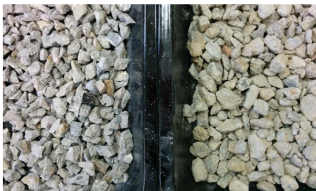
Obrázok 19: Betónový recyklát frakcia 8/16 mm - vľavo Velká Bíteš, vpravo Spiroll
