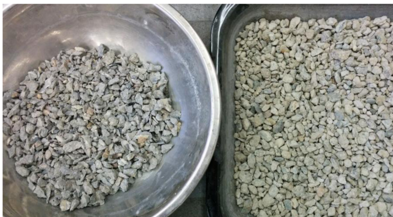
Obrázok 18: Betónový recyklát frakcia 4/8 mm - vľavo Velká Bíteš, vpravo Spiroll
