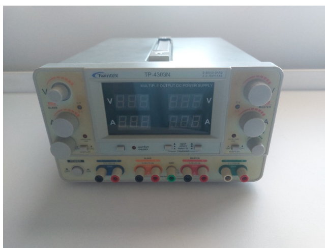
Obrázek 2.7: Napájecí zdroj TP-4303N značky Twintex.
