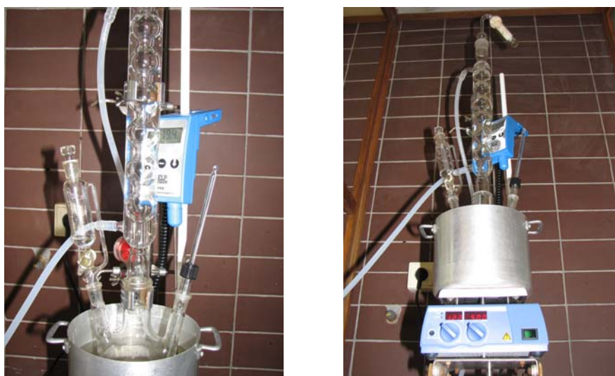
Obr. 18: Sestavená aparatura pro syntézu membrány
