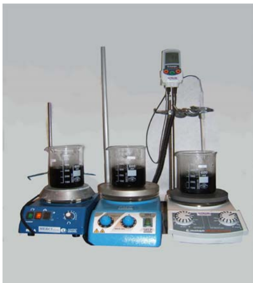
Obr. 47: Chemická příprava teflonování uhlíku
