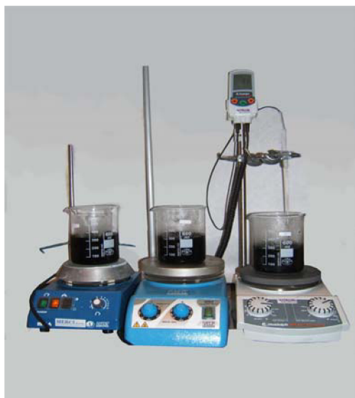
Obr. 47: Chemická příprava teflonování uhlíku
