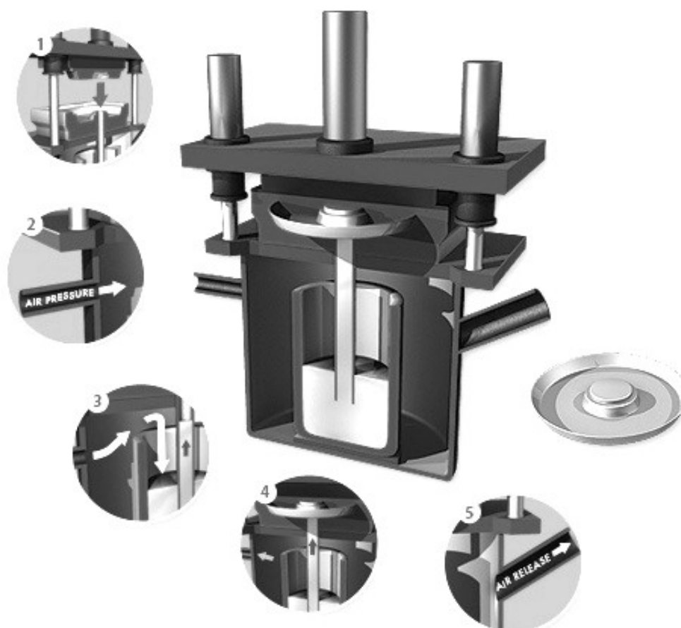
Obr. 6 – Schéma výroby odlitku nízkotlakou technologií [11]
