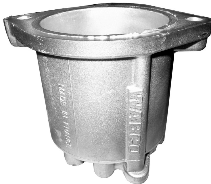
Obr. 10 – Odlitek tělesa spojky
