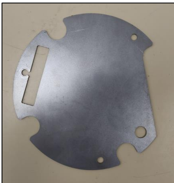
Obr. 15 – Mezidesková stínící vložka
