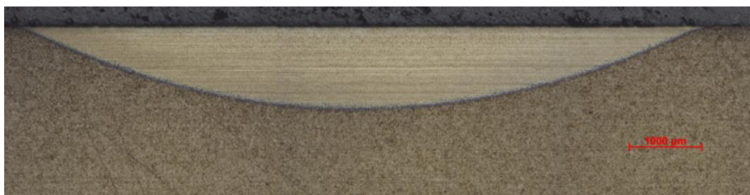
Obr. 24 : Makrostruktura vzorku P4 na SM
