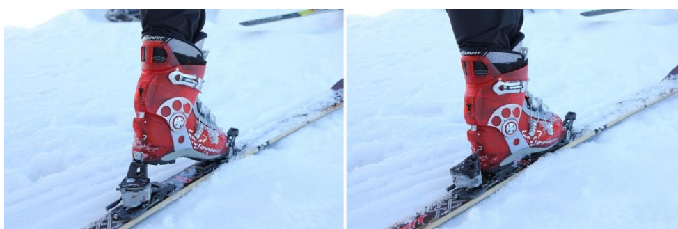
Obrázek 37: Nastavení vázání na chůzi, vlevo – o dvě polohy, vpravo – poloha na sjezd (zdroj: vlastní).
