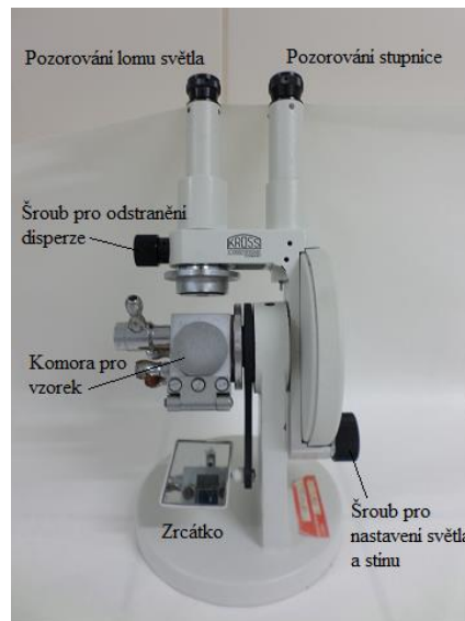
Obr. 6 Abbé refraktometr (Zdroj: archiv autora)
