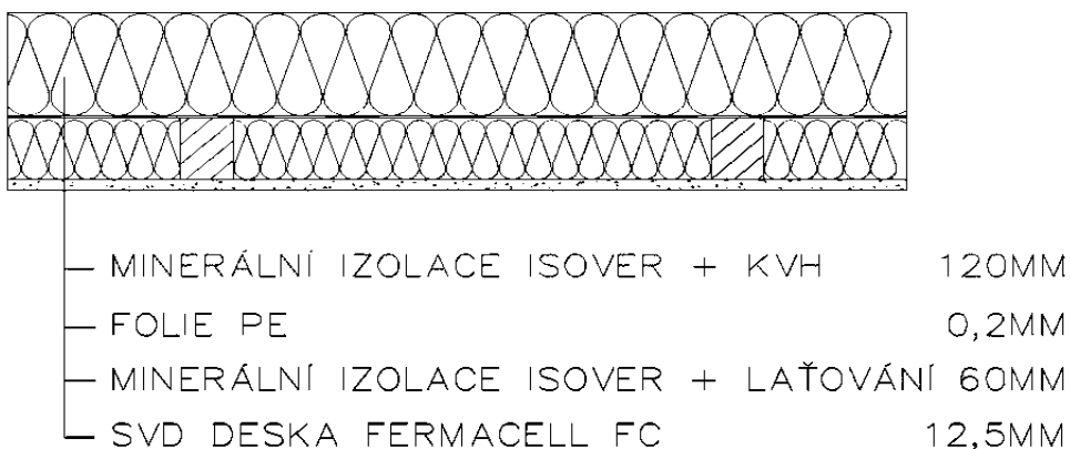
Obr. 21 Skladba stropu podkroví
