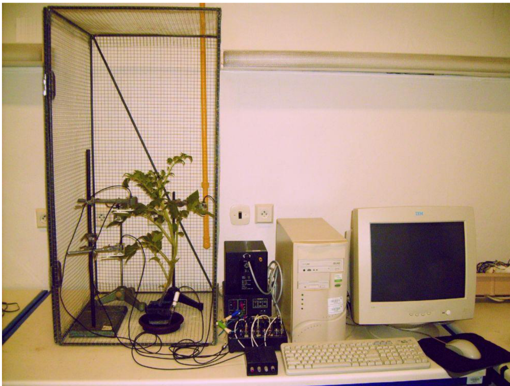
Obr. 2: Vícekanálová aparatura pro povrchové měření elektrického potenciálu podle Ilík et al. (2010).
