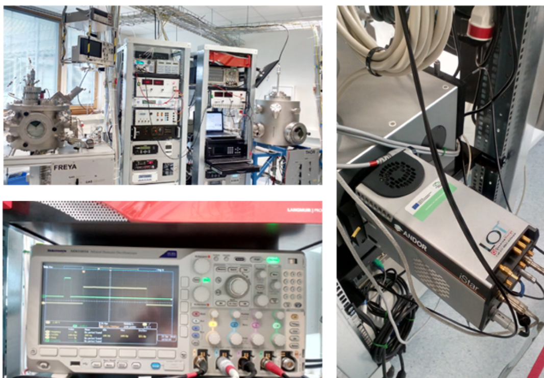
Obrázek 4.1: vlevo nahoře - laboratoř fyziky plazmatu PřF JČU; vlevo dole - osciloskop; vpravo - iCCD kamera Andor New iStar a spektrometr Andor SR-500
