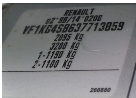
Obr. 20 VIN na typovém štítku
