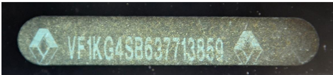
Obr. 19 VIN pod čelním oknem
