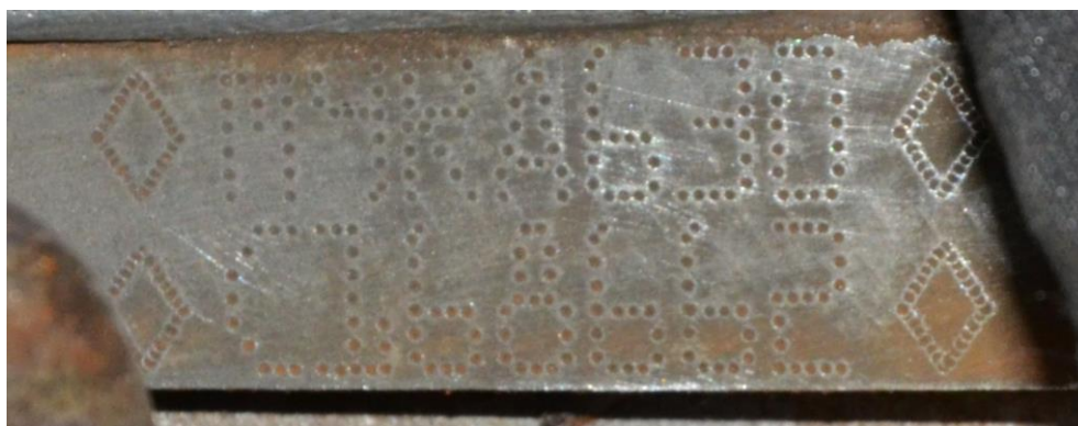
Obr. 25 Označení typu a výrobního čísla motoru
