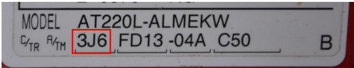
Obr. 9 Kód barvy na typovém štítku (TOYOTA)
