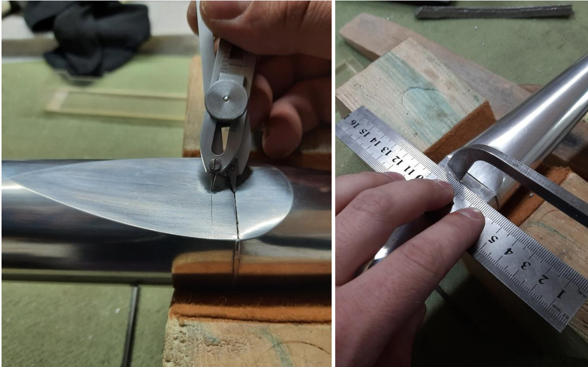
Obr. 55 Rýsování výšky výřezu poměrovým kružítkem. Obr. 56 Vyřezávání výřezu rajzhákem.
