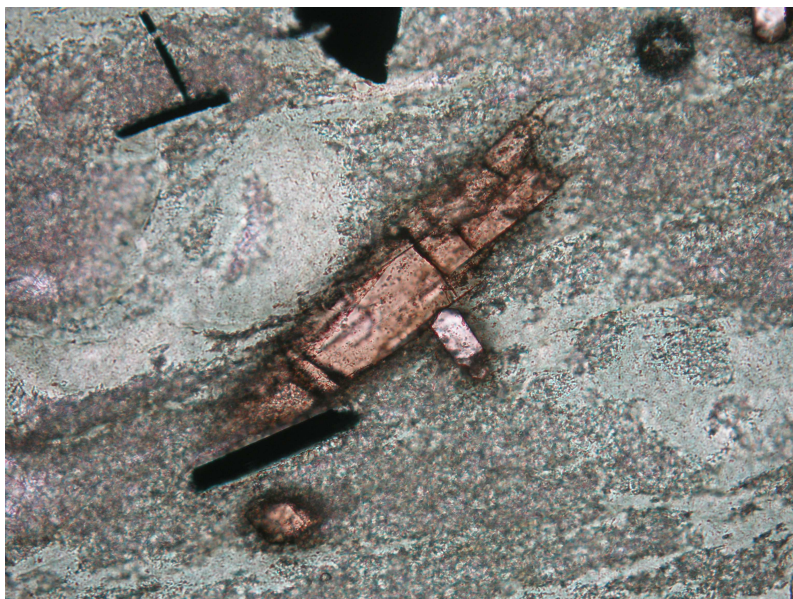
Obr. 27. Podlouhlé rozpraskané zrnó allanitu-(Ce) s černými tabulkami (lišťovitými průřezy) ilmenitu v chloritové rudě. Výbrus CHAB –LE-1, který je mírně podbroušený. PPL, šířka snímku 0,6 mm.
