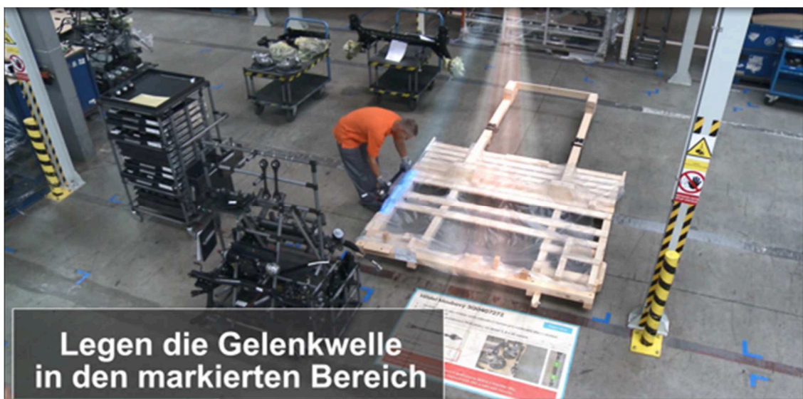
Obr. 2.19 Osvícení správného místa na umístění dílu + textová informace
