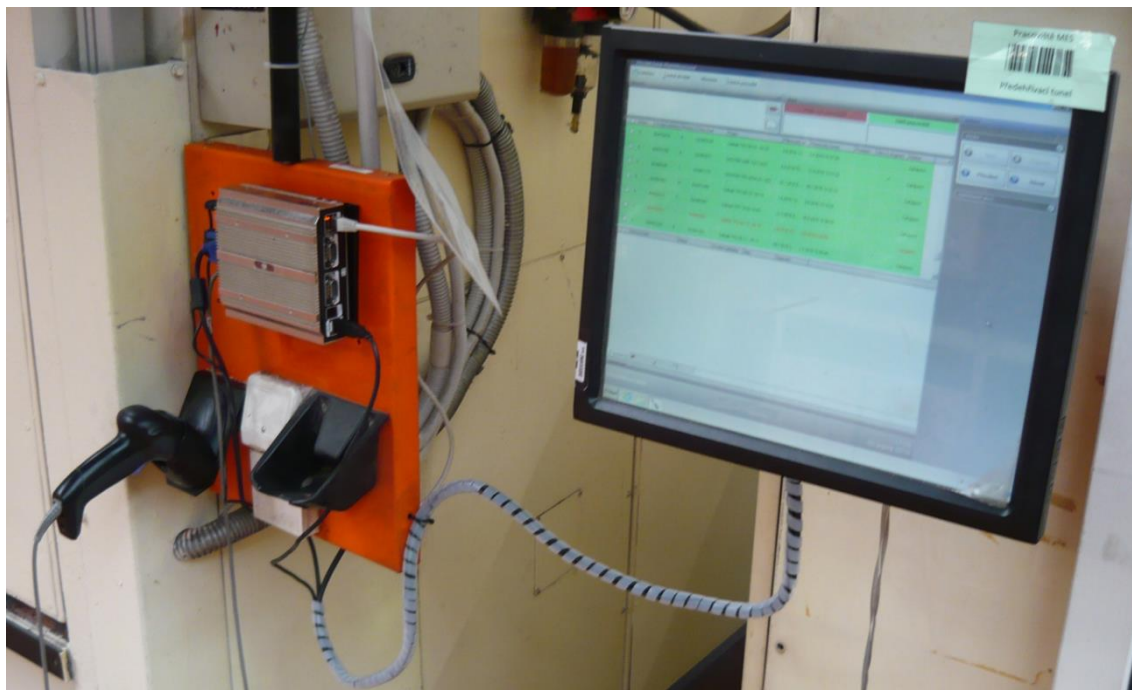
Obrázek 2: Běžné pracoviště s průmyslovým PC – terminálem
